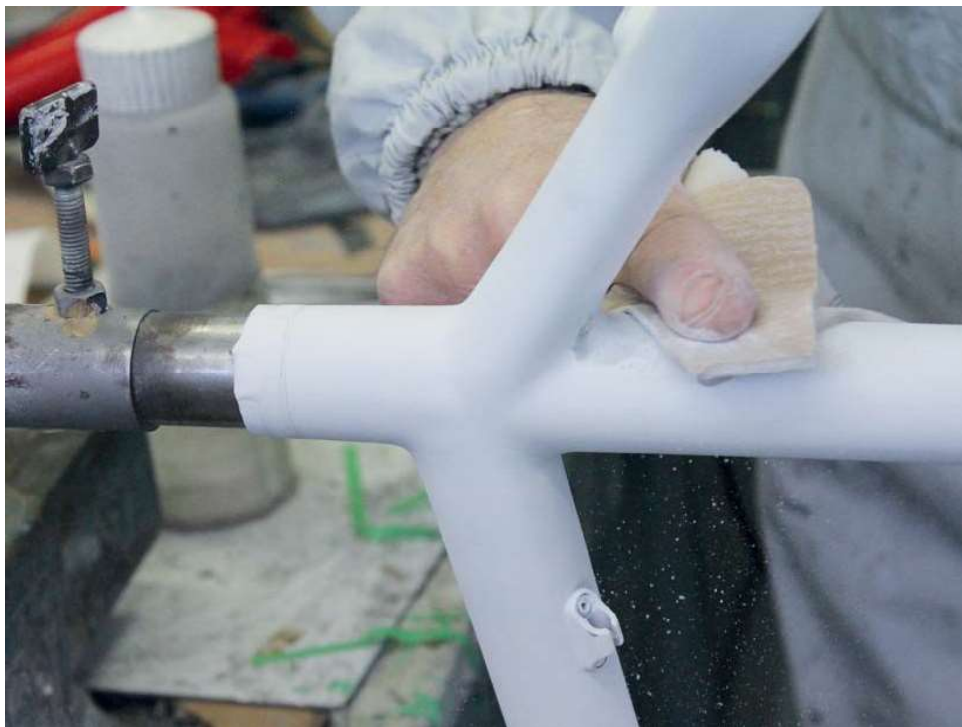
Lo stucco una volta asciutto è eliminato attraverso una fase di carteggiatura.
