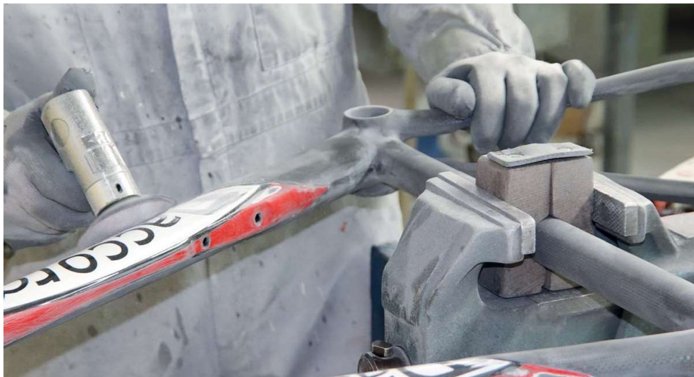
Il processo di applicazione delle decalcomanie sul telaio.
